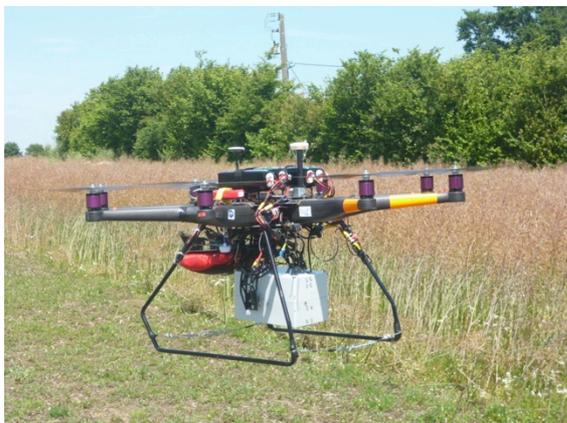
(figure n°1 drone hyperspectrale en vol )
