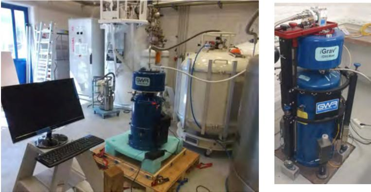
Gravimètre supraconducteur iGrav (pendant un remplissage d'hélium liquide à gauche et installé sur un pilier à l'Observatoire Gravimétrique de Strasbourg).
