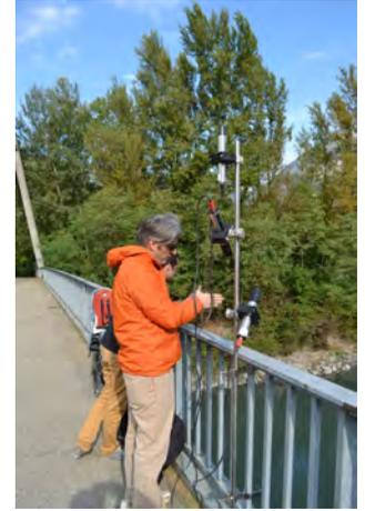
Fig. d : Mesures des propriétés optiques de l'eau à l'aide de radiomètres
