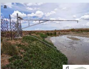
Fig. 2: a. La rivière Katari avec le radar et le tube contenant le conductivimètre et le tuyau d'aspiration pour l'ISCO; b. Jauge Owen et pluviomètre; c. datalogger Arduino et sonde d'humidité du sol; d. Prélèveuse ISCO
