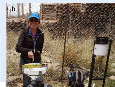
Fig. 2: a. La rivière Katari avec le radar et le tube contenant le conductivimètre et le tuyau d'aspiration pour l'ISCO; b. Jauge Owen et pluviomètre; c. datalogger Arduino et sonde d'humidité du sol; d. Prélèveuse ISCO
