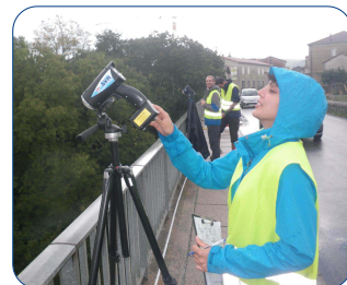
Jaugeages sans contact par radar mobile pendant une crue de l'Auzon
