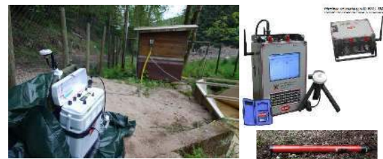
Equipements CRITEX avec émetteur et récepteurs synchronisés par GPS : à gauche l'émetteur T3, à droite le récepteur V8 présenté ici avec une sonde magnétique, et le contrôleur RXU-TMR pour la synchronisation
