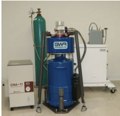
Gravimètre supraconducteur de type iGrav
