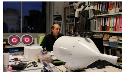
Préparation au labo du scintillomètre à extra-large ouverture Scintec-BLS2000 avant déploiement sur le bassin-versant de l'Orgeval (observatoire ORACLE).
