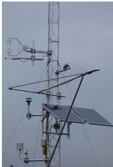
Orgeval : Récepteurs des scintillomètres infrarouge et micro-onde (gauche) et station d'Eddy-covariance (à droite)
