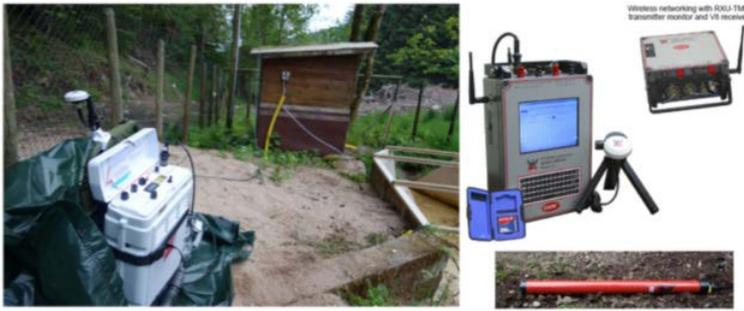
Équipement CSAMT avec émetteur et récepteur synchronisé au GPS : à gauche émetteur T3 en fonctionnement près de l'exutoire du bassin versant du Strengbach (juin 2015)
